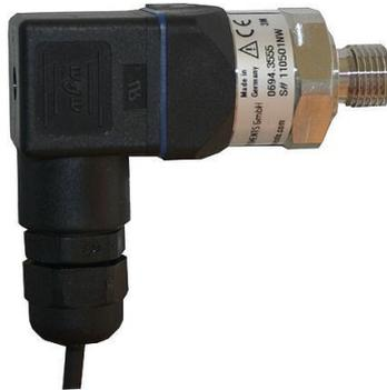
Стандартный датчик давления CS 40 для степени повышения давления 0...40 бар измеряет с точностью макс. 1% полной шкалы. Для более точного измерения при той же степени повышения давления мы предлагаем датчики CS 40 с точностью 0,5% полной шкалы.
