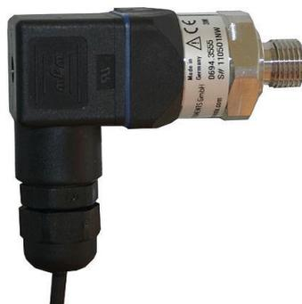
Стандартные датчики давления CS 10 и CS 16 для степени повышения давления 0...10 бар и 0...16 бар измеряют с точностью макс. 1% полной шкалы. Для более точного измерения при той же степени повышения давления мы предлагаем датчики CS 10/CS 16 с точностью 0,5% полной шкалы.
